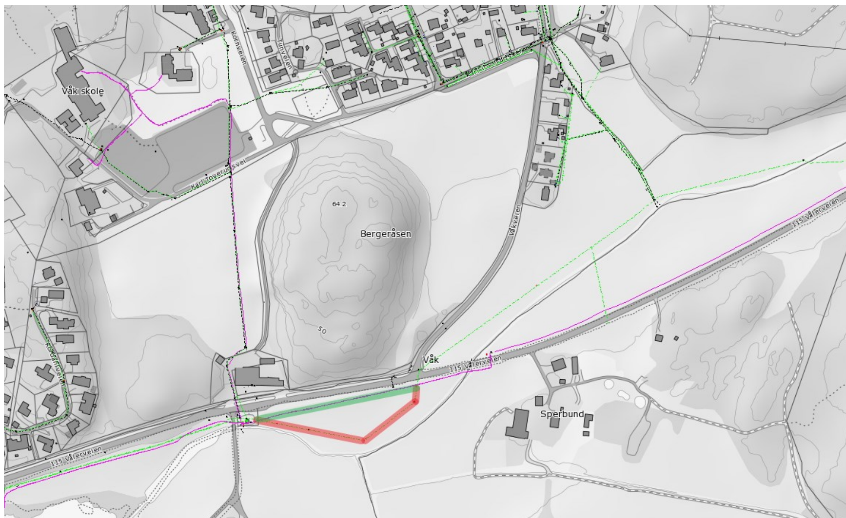
A1 - Spillvannsledning fra Våk til Sperbund pumpetasjon, mye innlekkning fra bekken
