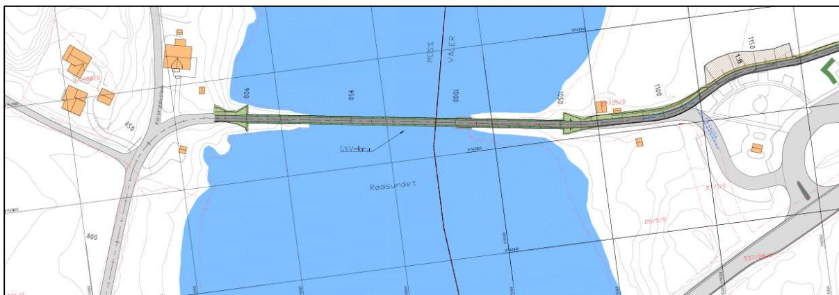
Under vises de tre ulike alternative bruløsningene som vurderes. Alle alternativene ligger med samme høyde over vannspeilet. Høyden er bestemt med bakgrunn i 200-årsflom. For å unngå fundamentering midt i sundet, samt et for stort buespenn, er det valgt to korte sidespenn og et hovedspenn på 52,5 meter. Buen er på det høyeste 7,5 meter. Videre detaljering av de tre alternativene avklares i neste fase. Illustrasjonen viser hvordan man antar at det kan bli.
