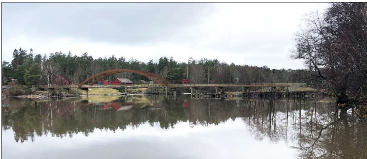
Figur 5-9: Alternativ 3. Lang bru på søyler oppå dagens landkar og tilløpsfyllinger. Kilde: Multiconsult
