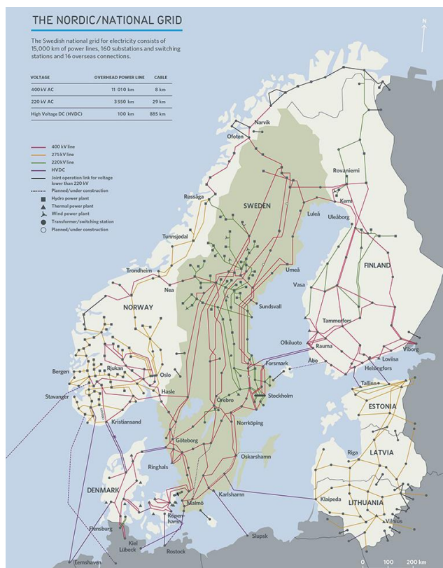
Figur 1- Oversikt over Kraftnettet i Skandinavia
